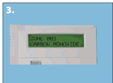
Verifique el aviso de alarma en el panel de control. El detector saldrá del modo de prueba en forma automática durante siguientes 20 a 60 segundos.
