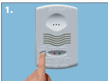
Presione y mantenga retenido el botón de prueba por dos segundos hasta que entre en modo de Prueba Real. El LED verde destellará cada segundo indicando esto.
